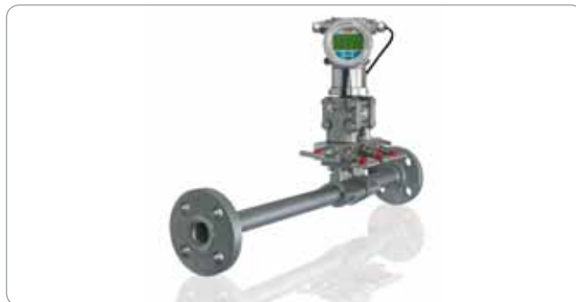
Obr. 4 Prietokomer FPD510 IOMaster s výmennými clonami a stišujúcimi úsekmi potrubia pred prietokomerom i za ním
